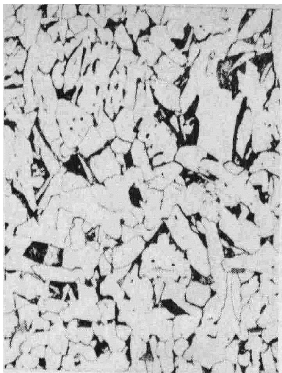
16-rasm.Po'latning kristall atom tuzulishi
