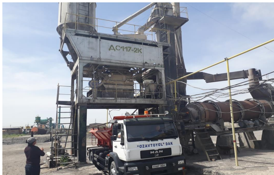
13-расм. Тайёр бўлган асфальтобетон қоришмасини махсус автомашинага тўкиш жараёни.
