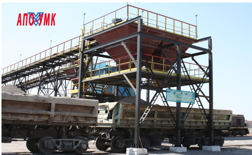
11-расм. Қаттиқ чиқиндиларни майдалаб иккиламчи маҳсулотга айлантириш қурилмаси.
