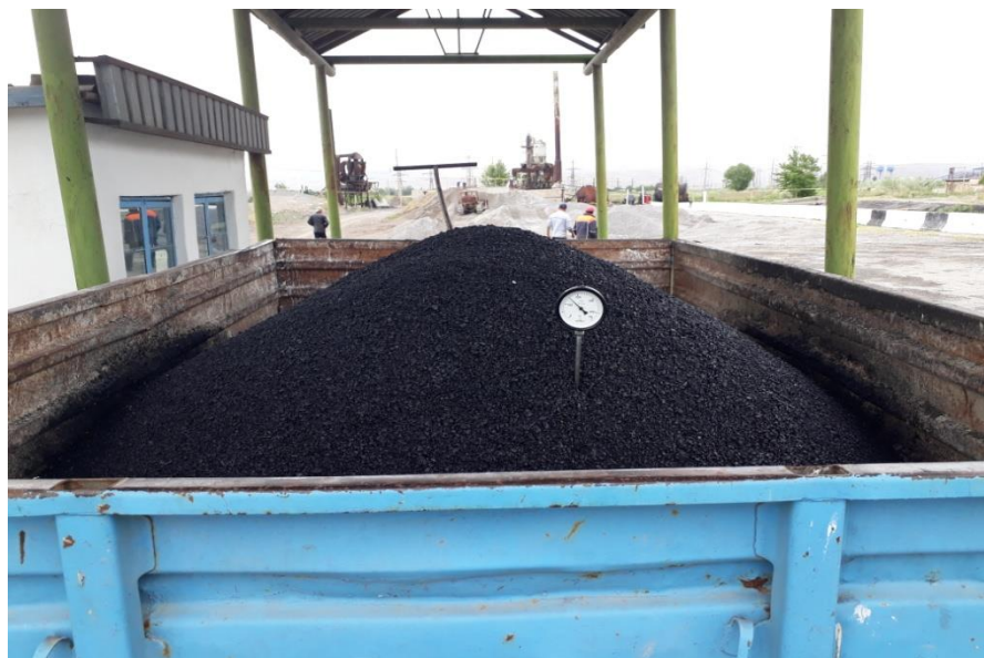
12-расм. Тайёр асфальтобетон қоришмасини харорати ва оғирлигини ўлчаш жараёни
