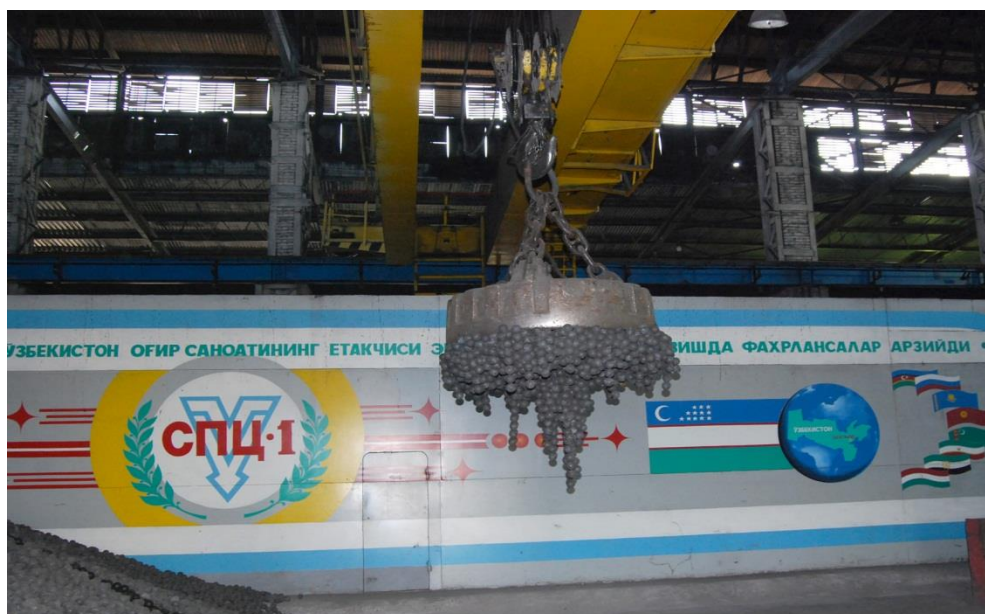
18-расм.1 – навли прокат цехи тайёр бўлган шарларни ўлчами бўйича ажратиш жараёни.
