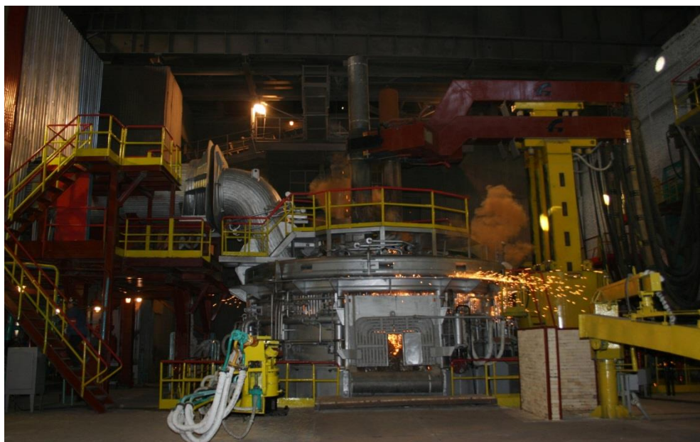
2-расм. Электрда пўлат эритиш цехи, ДСП – 100 УМЗ пўлат эритиш печи, “Печь-ковш” қурилмаси
