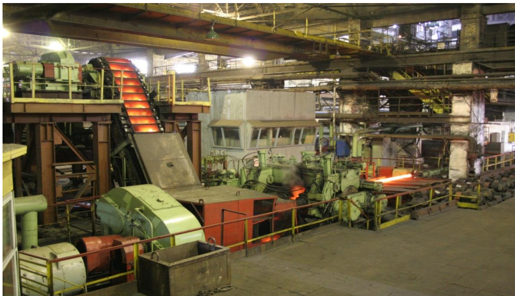
17-расм. 1 – навли прокат цехи, шарларни ўлчам бўйича қўйиш қурилмаси
