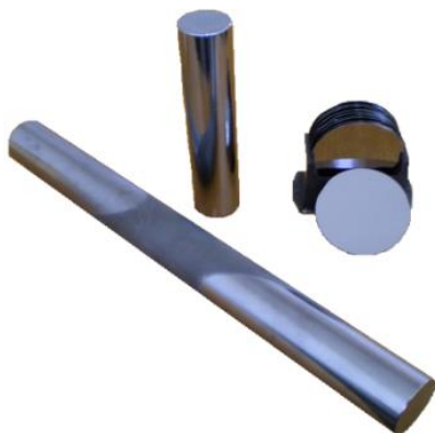
2.11. – rasm. Choxral usuli bilan olingan Si monokristali.
