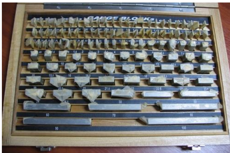
3.6 –rasm. uzunlikning chekka o‘lchovlari to‘plami (Majmua KMД №3, aniqlik sinfi - 0,1,2,3; po‘lat)
