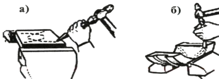
5.8-rasm. Moylash ariqchasi va o'yiqlarni kesish: a – yassi sirt; b – botiq sirt.
