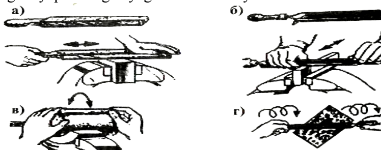
7.10-rasm: Egovlangan sirtni pardoqlash: a – yog'och brusga yopishtirilgan qumqog'oz bilan; b – egovga o'ralgan qumqog'oz bilan; v – qavariq yuzani tozalash; r – aylanma shtrixlar bilan pardoqlash.
