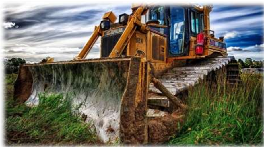
Рис. 2.6. Бульдозер Б10М (на базе трактора Т10М) на испытаниях по производительности
