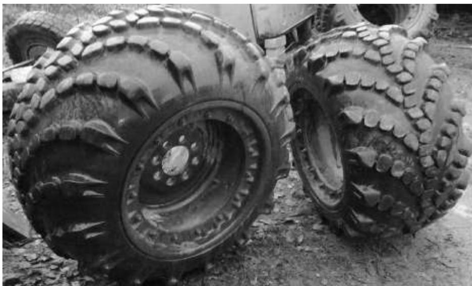
Рис. 1.3. Арочные шины
