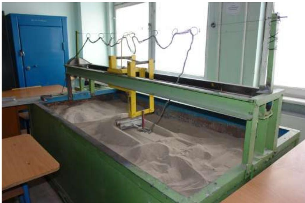
Рис. 3.4. Стенд физического моделирования для экспериментальных исследований рабочих процессов строительно-дорожных машин.
