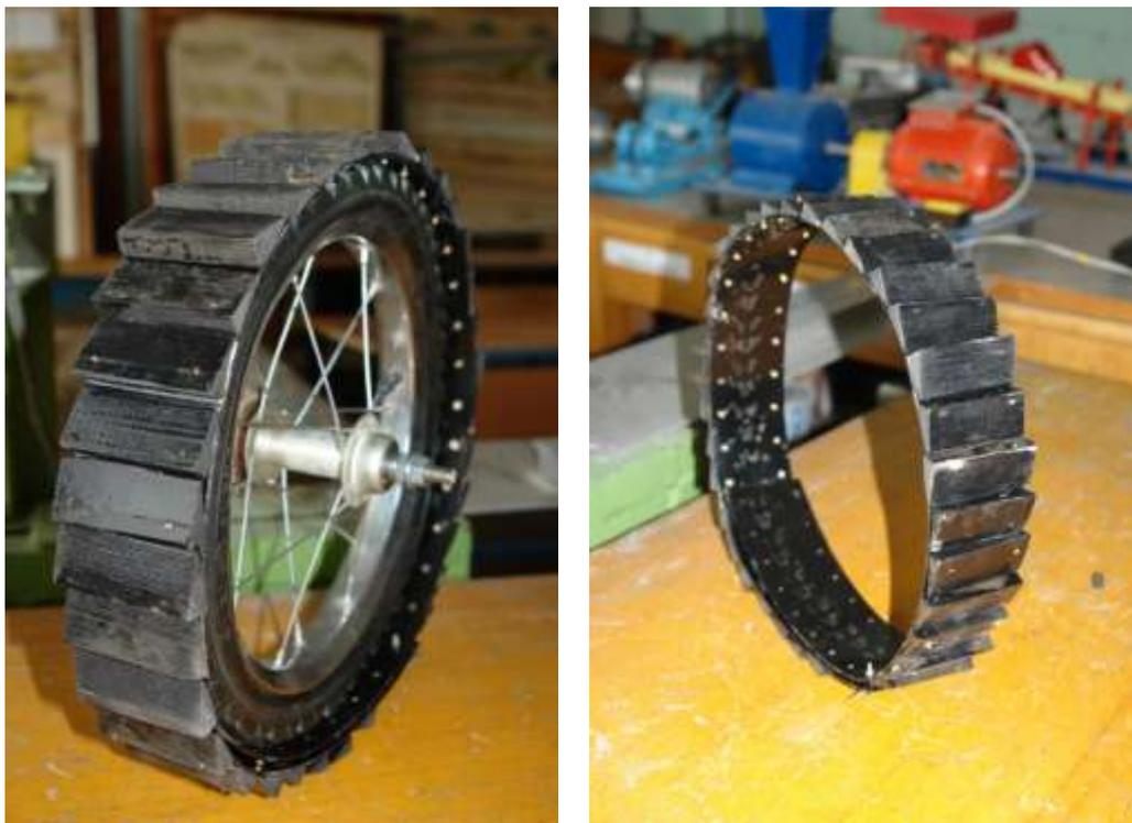
Рис. 3.3. Модельное колесо с грунтозацепами различной формы.
