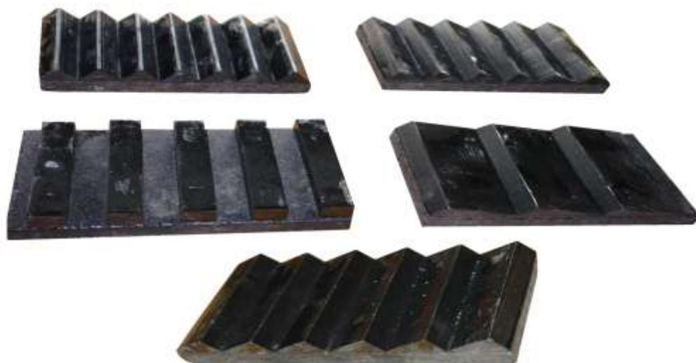
Рис.3.5. Модельные плиты с грунтозацепами для предварительных экспериментальных лабораторных исследований.
