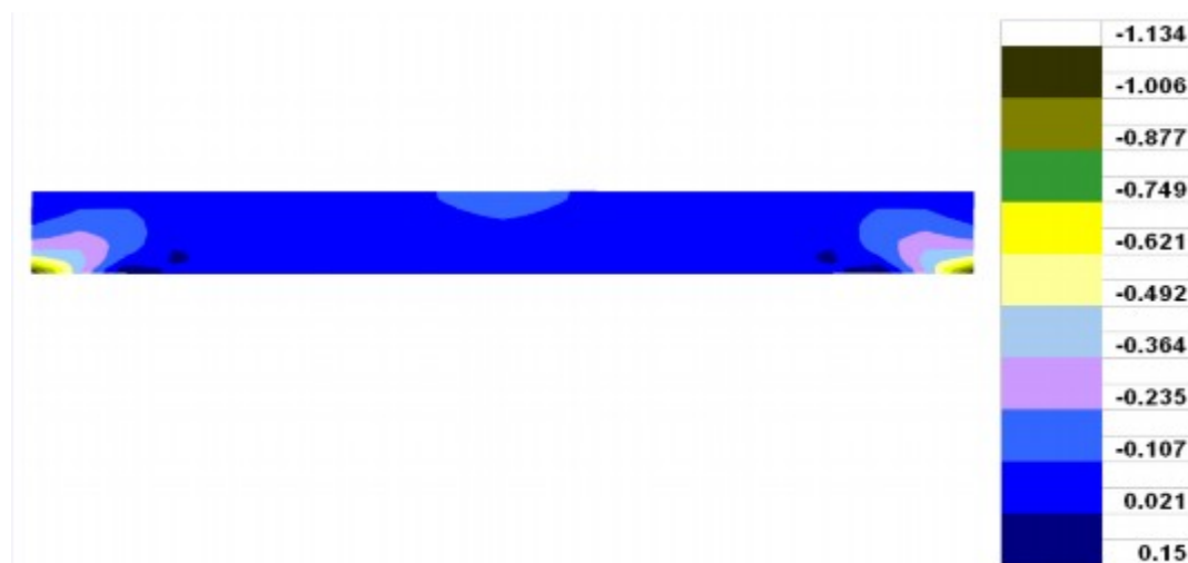
Расм. 8 Доимий ва А14 аравали вақтинчалик юкдаги оралиқ қурилмани плитаси ҳисобининг натижалари: а) горизонтал кучланишлар изоҳромлари, б) вертикал кучланишлар изоҳромлари
