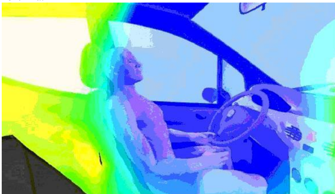
Рис. 2. Распределение температуры воздуха в салоне автомобиля
