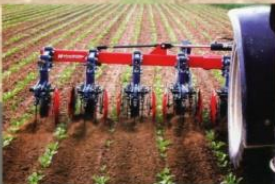
Обработка сахарной свеклы пропашной машиной компании «Хатценбихлер»
