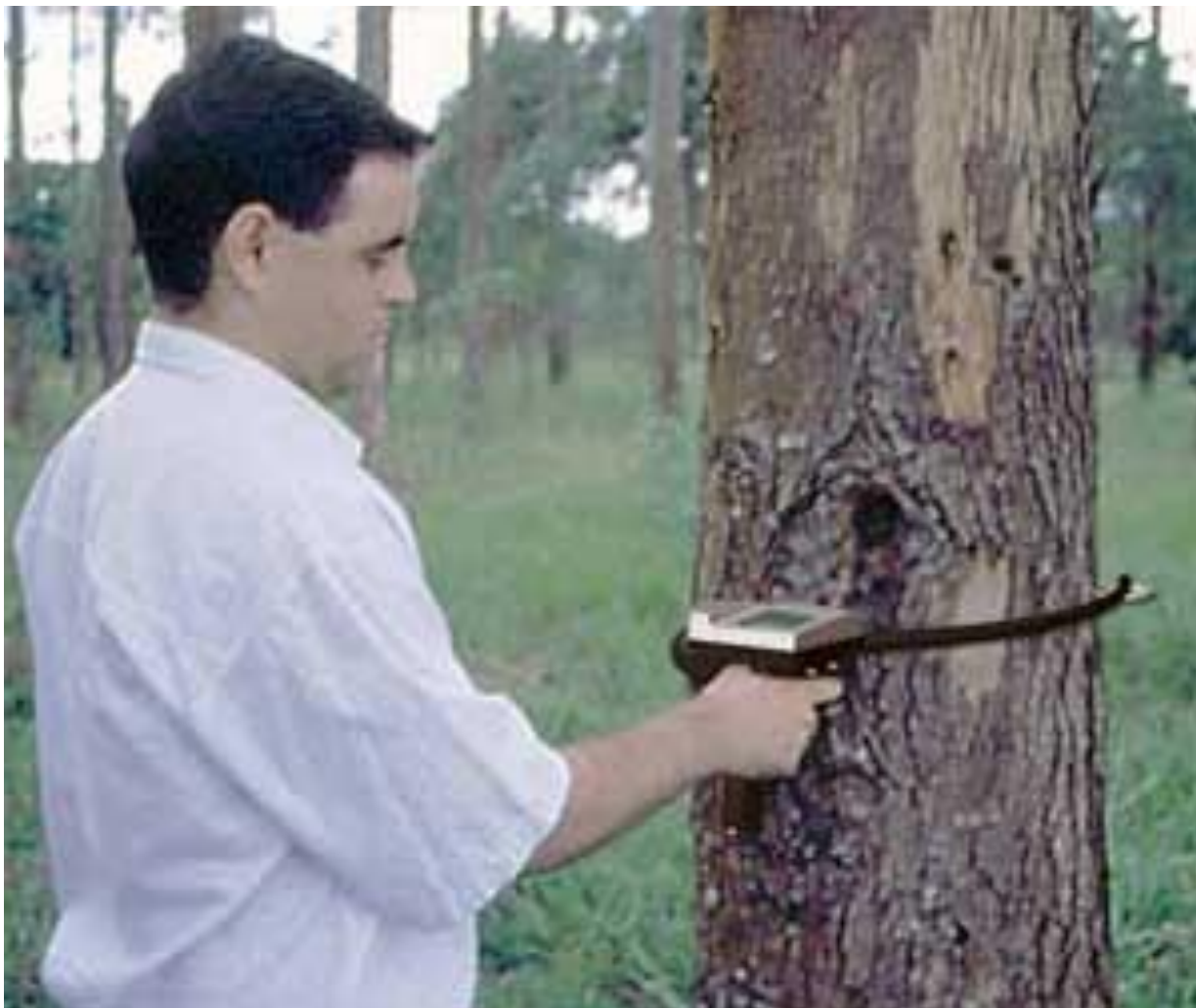
5.2-расм. Ўсиб турган дарахтнинг ёғоч захирасини электрон ўлчов асбоби ёрдамида аниқлаш
