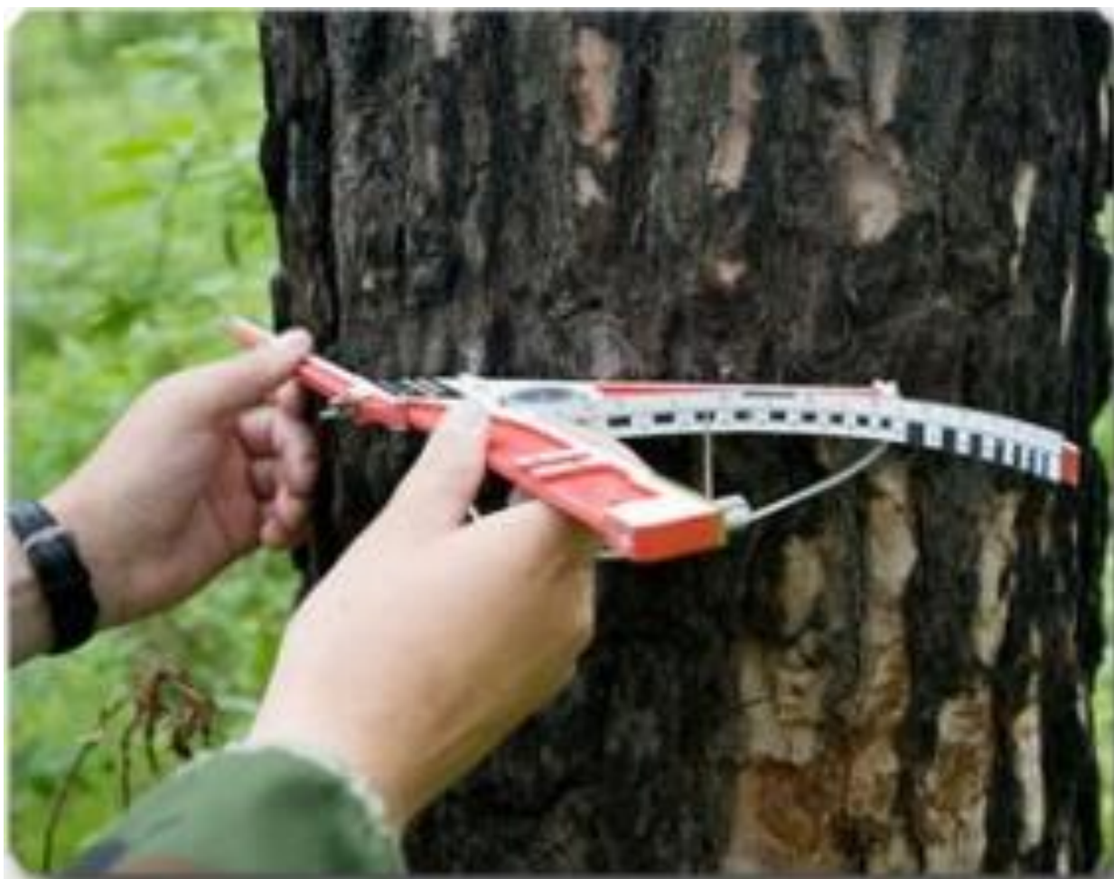
12.1-расм. Дарахт танасининг 1.3 м баландликда диаметрини электрон ўлчов асбобида аниқлаш.
