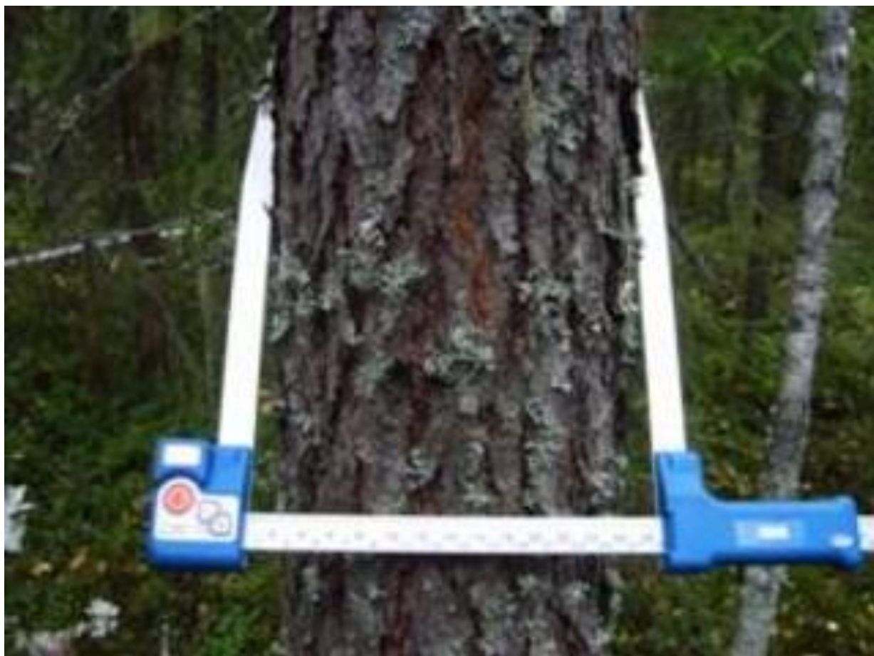
6.1-расм. Дарахт танаси диаметрини 1.3 м баландликда ўлчов асбоби ёрдамида аниқлаш.
