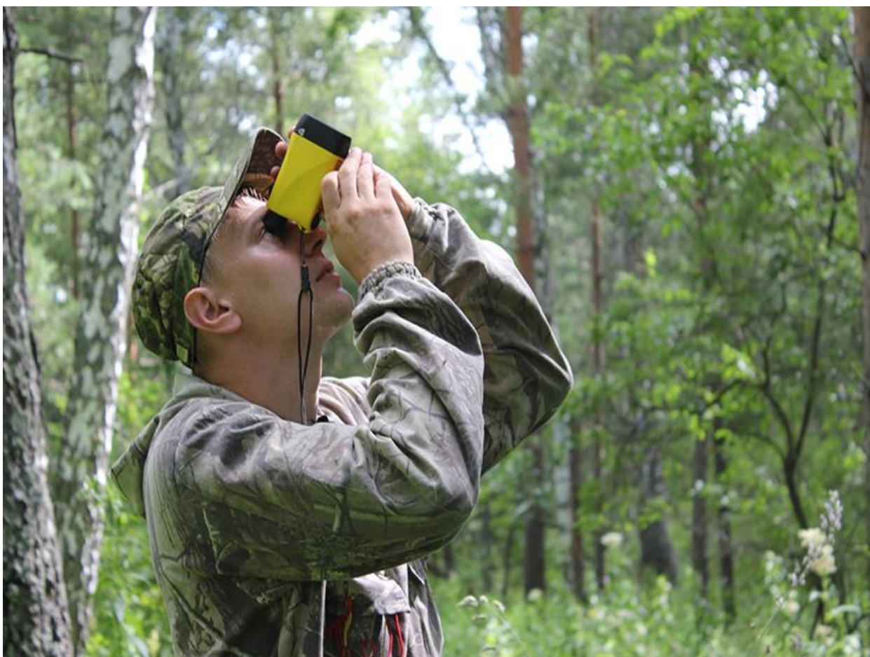
8.1-расм. Ўрмон дарахтларини баландлигини баландлик ўлчагич асбоби (высотомер) ёрдамида аниқлаш
