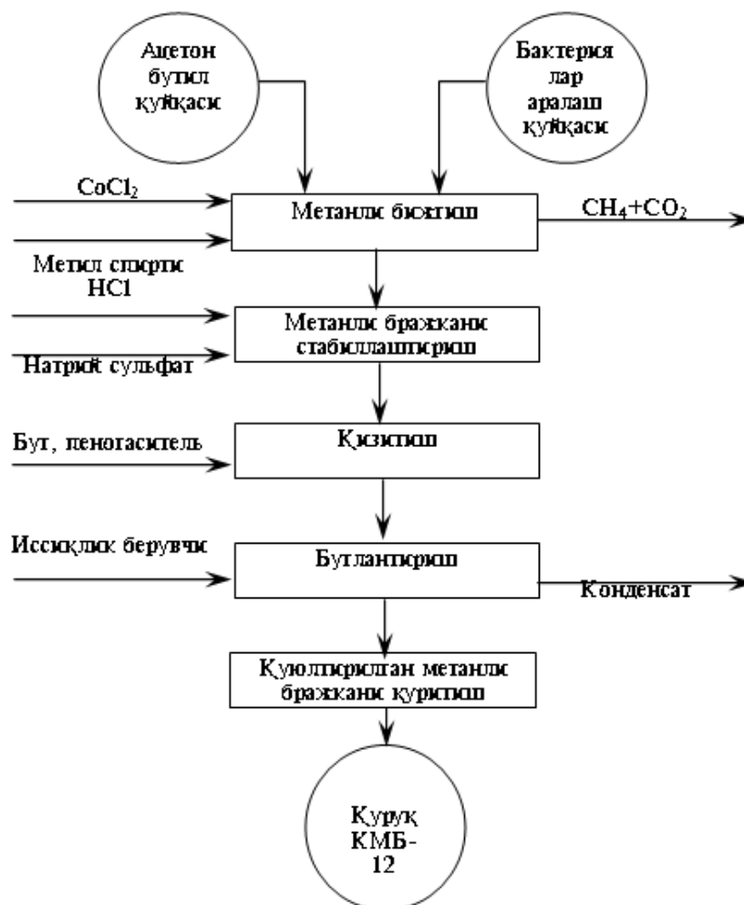
6-чизма. Озиқа концентрати В 12 - витаминини ишлаб чиқаришнинг технологик чизмаси
