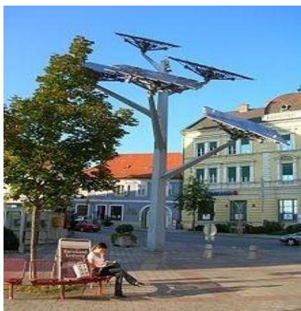
12.18-rasm. Quyosh batareyasi joylashtirilgan daraxt shaklidagi mikroelektr stansiya.
