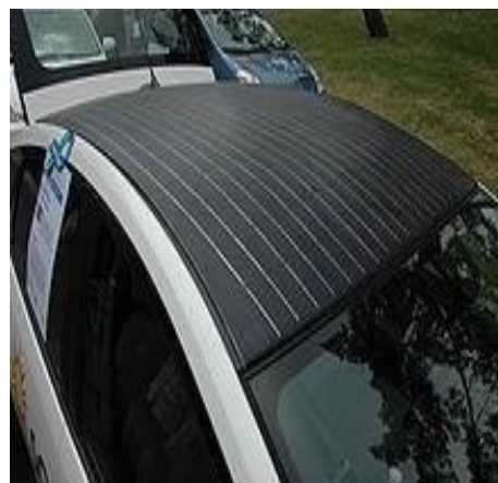
12.19-rasm. Elektr qismlarini zaryadlash uchun mo'ljallangan avtomobil tomida joylashtirilgan quyosh batareyasi.
