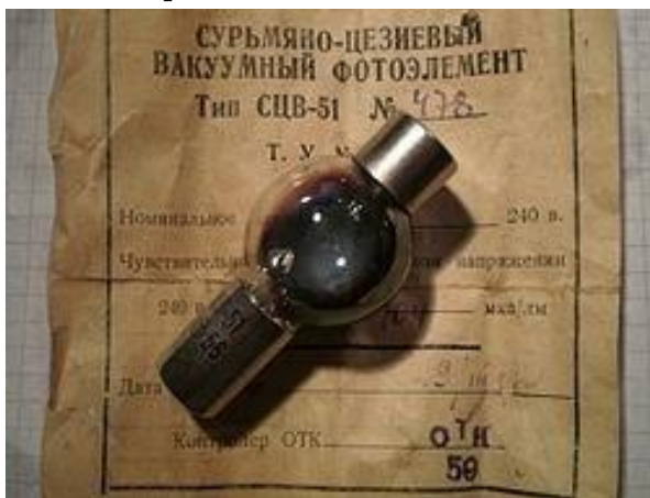
12.16-rasm. Surma-seziy asosida tayyorlangan fotoelement.
