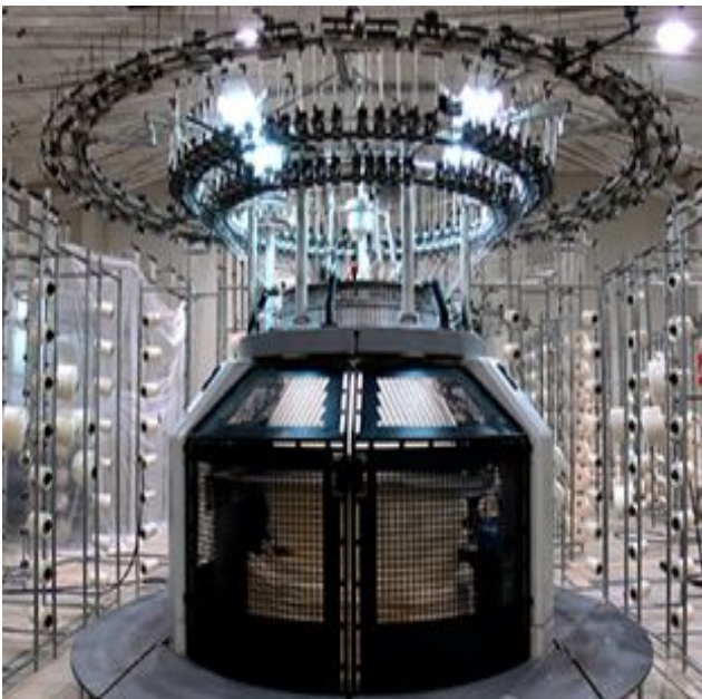
39-rasm. Aylana ignadonli trikotaj to'quv mashinalari.
