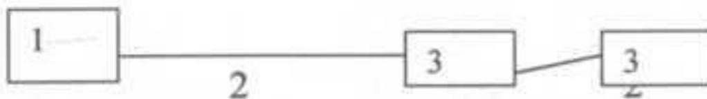
4.6- расм. ЭПС схемаси: 1 - қабул қилувчи станция; 2- симлар; 3 - датчиклар.
