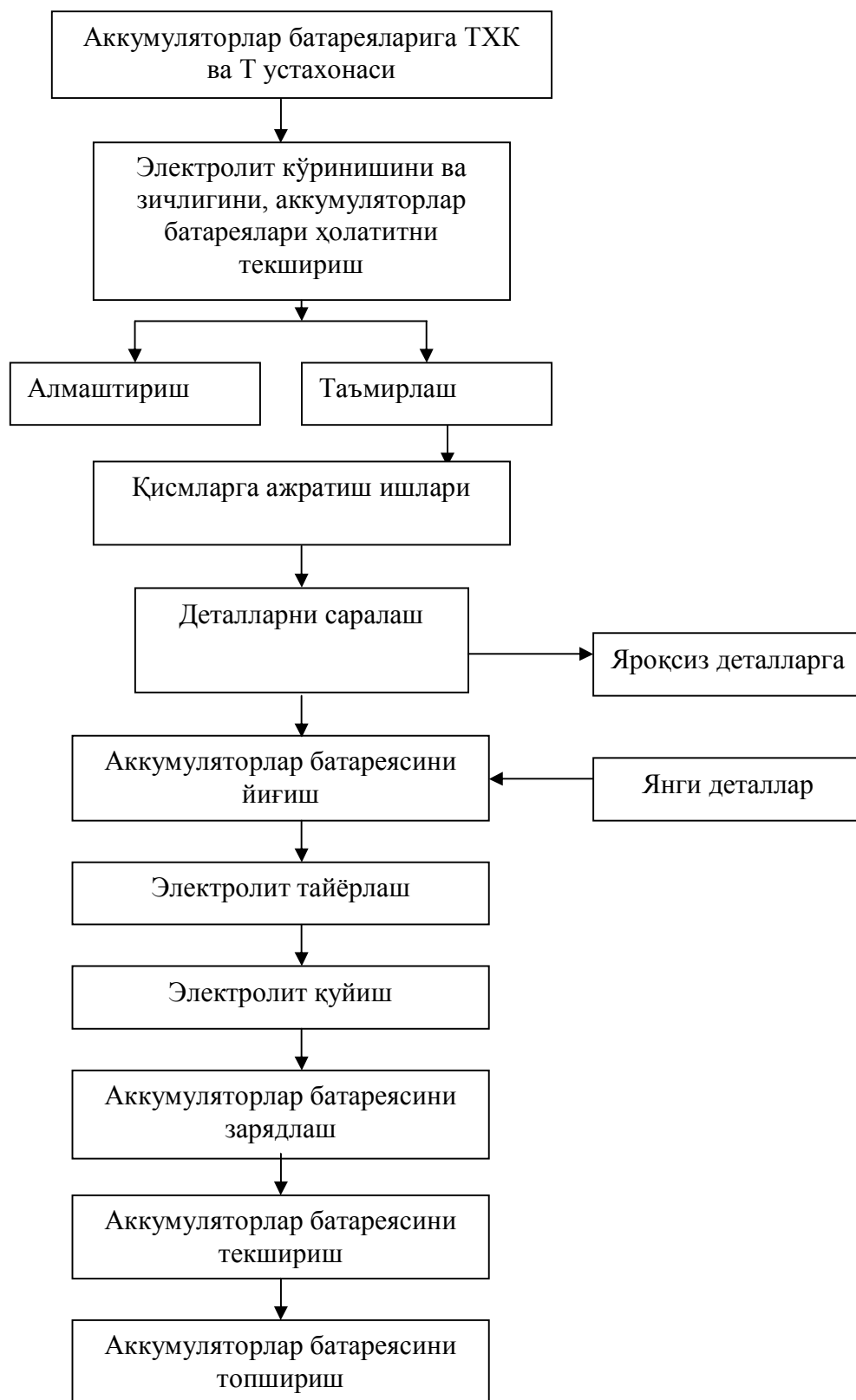
3.1-rasm. Akkumulyatorlar ustaxonasida bajariladigan ishlarni texnologik jarayoni shakli Akkumulyatorlar batareyasini qabul qilib olishda, uning holti, zaryadlanganligi va elektrolit zichligi tekshiriladi. Zichligi me'yoriydan kam bo'lganda 1,41 \text{ g/sm}^3 zichlikka ega bo'lgan elektrolit quyiladi.
