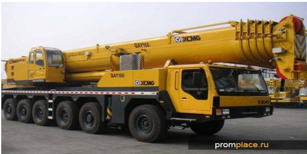
3-rasm. Avtomobil tipidagi maxsus shassilariga o'rnatilgan kran 16 .
