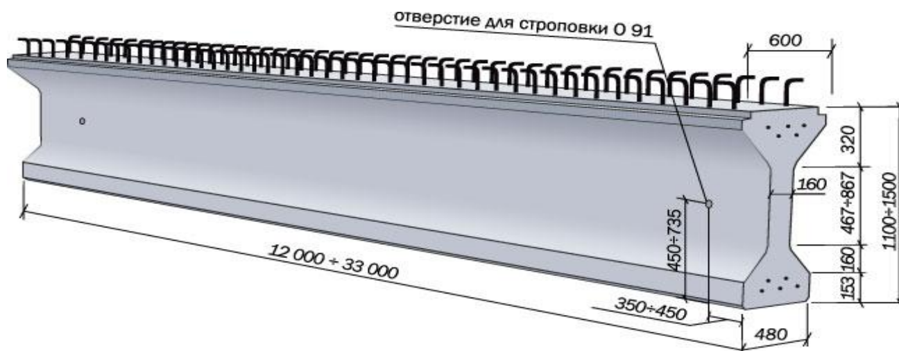
1-rasm. Temir yo'l to'sinida oldindan zo'riqtirilgan armaturalarning joylashish sxemasi.
