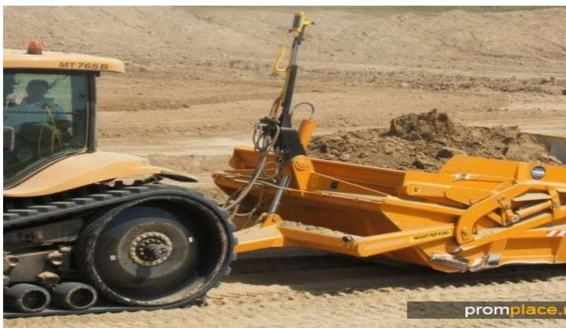
8-rasm. Tirkamali va o'zi yurar skreperlar tuzilish.
