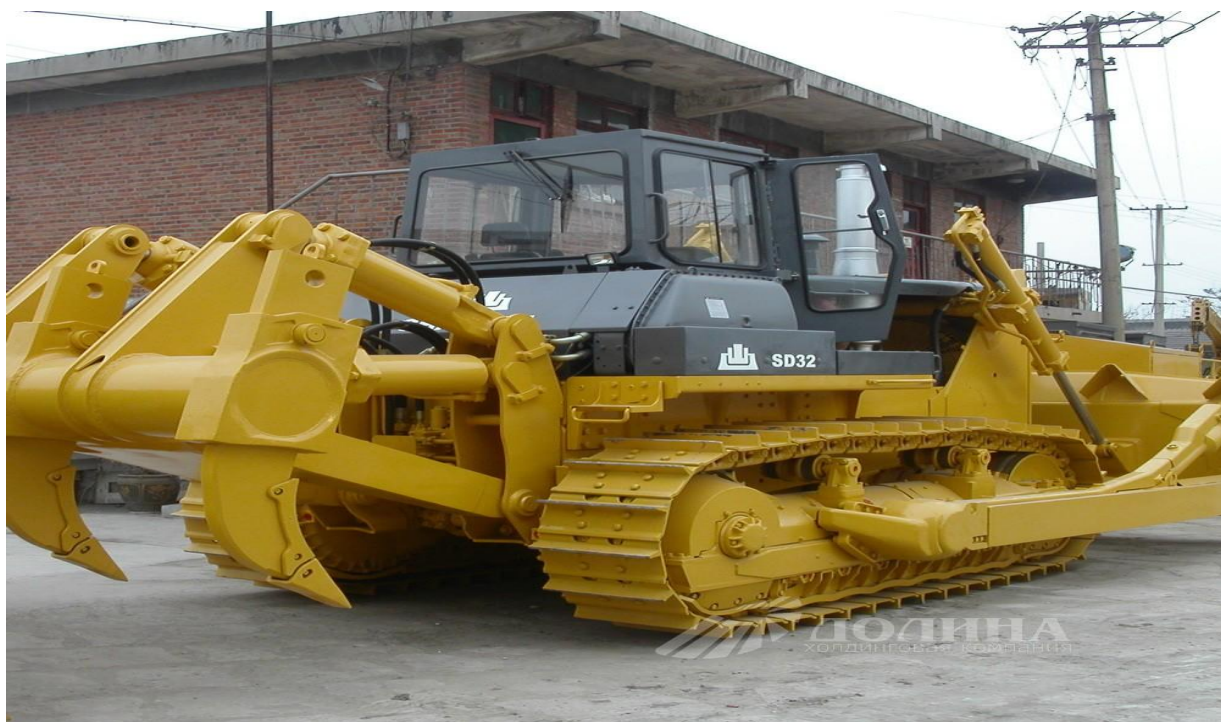
2-rasm. Zanjirli traktor tyagachlarga osilgan, gidravlik boshqariladigan yumshatish mashinasi.
