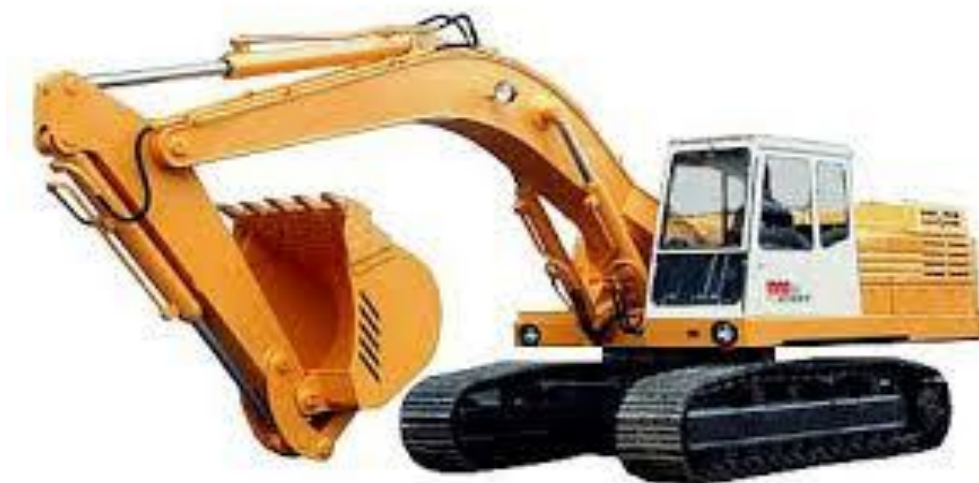
2-rasm. Cho'michi teskari joylashgan zanjirli ekskavator.
