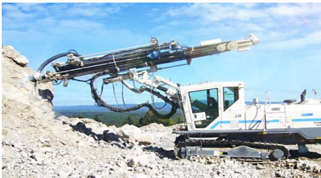
2-rasm. Zarbali usulda tog' jinsi dinamik siqich kuchlanishi natijasida buzish
