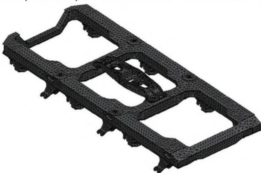
Рис.2. Идеализация рамы тележки тепловоза
