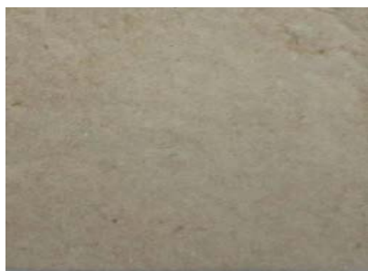
Базальт тола ва буғдой сомони целлюлозаси асосида олинган қоғоз (1:1)
