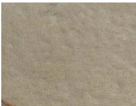
Базальт тола ва терак дарахти целлюлозаси асосида олинган қоғоз (1:1)
