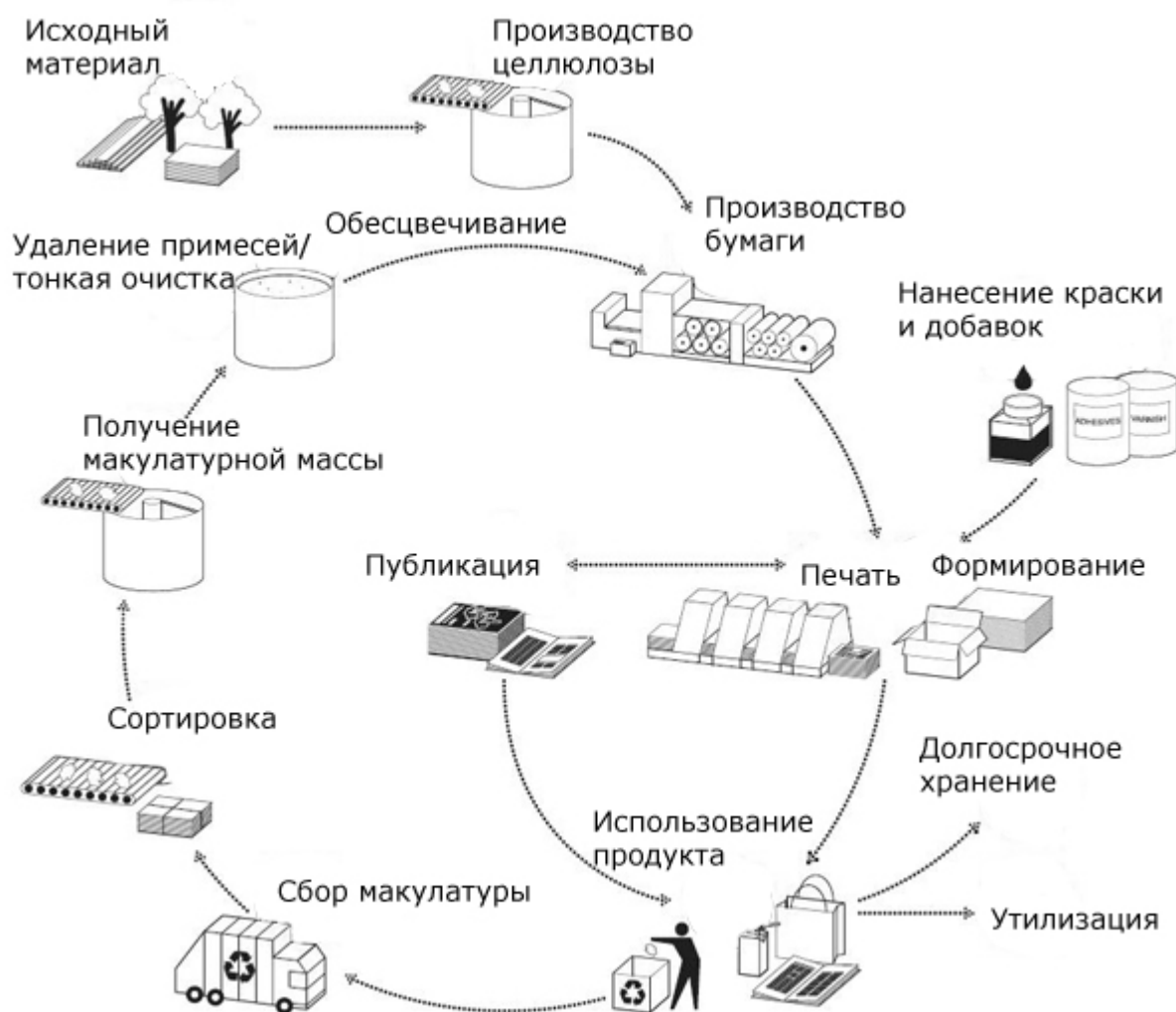
Рис. 1. Схема процесса переработки макулатуры в общем цикле производства и потребления бумажной продукции
