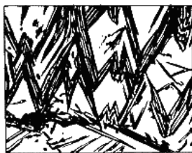
Рис. 13.2. Ориентированность кристаллов мартенсита
