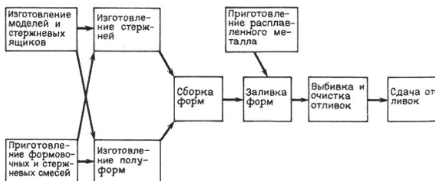
Рис. 8.1. Схема технологического процесса изготовления отливок в песчаных формах
