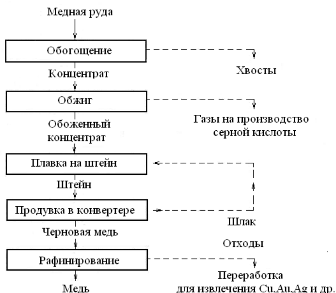
Рис.2.1. Упрощенная схема пирометаллургического производства меди
