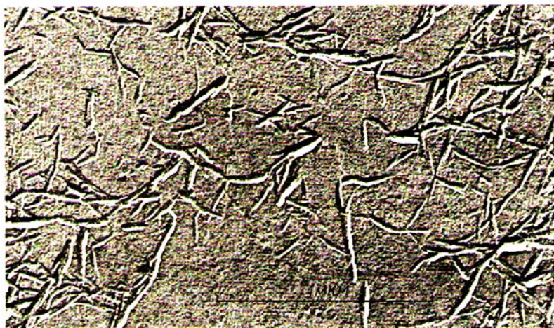
1.5-расм. Пишиб етилган пахта толасини кислотада гидролизлаб олинган фрагментларининг ўта зич жойлашган микрофибрилл структурасининг электрон микроскопдаги кўриниши.
