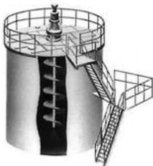
34-расм. Шнекли вертикал бассейннинг умумий кўриниши.
