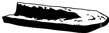
Рис. 5.22. Продольный разрез дозы расплава реактопласта при малом давлении пластикации.
