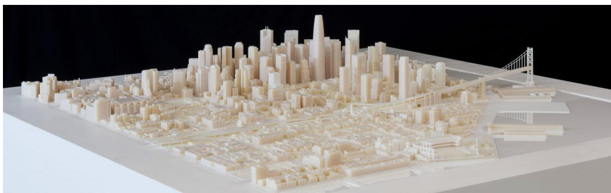
Рис.3.1. Градостроительный макет города Сан-Франциско, созданный компанией Autodesk и Steelblue с помощью 3D-принтера.
