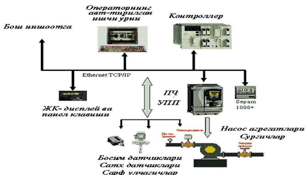
2.3.1– rasm. Nasos stansiyasini dasturiy boshqarish sxemasi.
