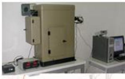
Вазифаси – ўлчаш кўлами 0,1 дан 100 mm гача бўлган намунавий (1-чи и 2-чи разряд ва аниқлик синфи 00 ва 0) чегаравий узунлик ўлчовларини қиёслаш ва калибрлаш.
