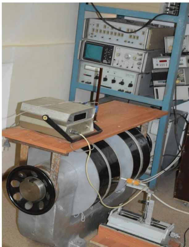
3.1 – rasm. Yupqa pardalar magnit qarshiligini o‘lchash qurilmasi.
