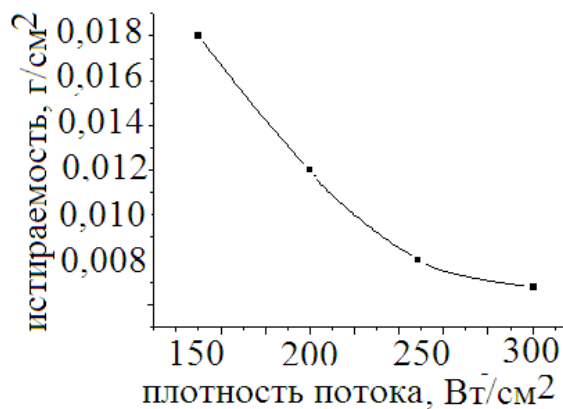
Рис.14. Зависимость истираемости пироксенового материала от плотности потока ( v_{\text{охл}} \sim 10^3 град/с)
