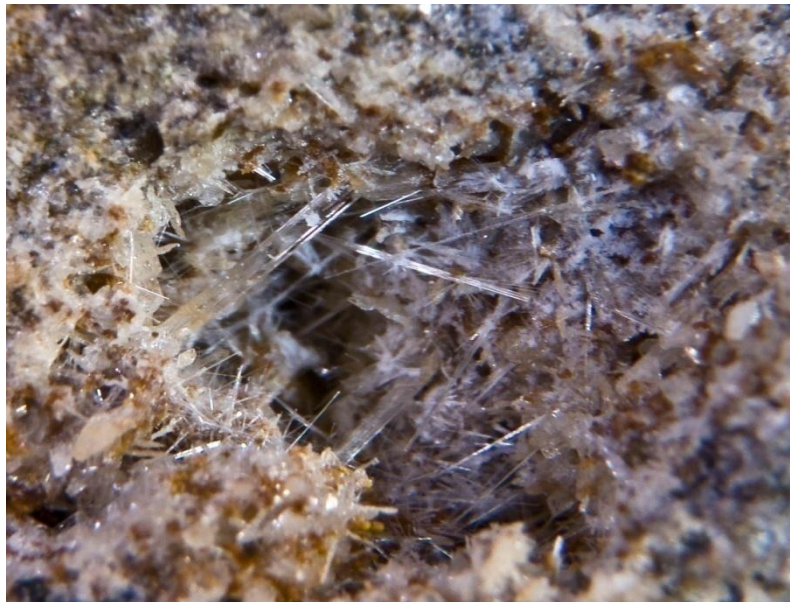
2.5-расм. Волластонитнинг микронасимон тузилиши (1700 марта катталаштириб олинган).
