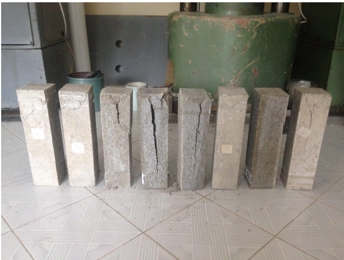
3.8-расм. Тажрибадан ўтказилган призма намуналарнинг умумий кўриниши
