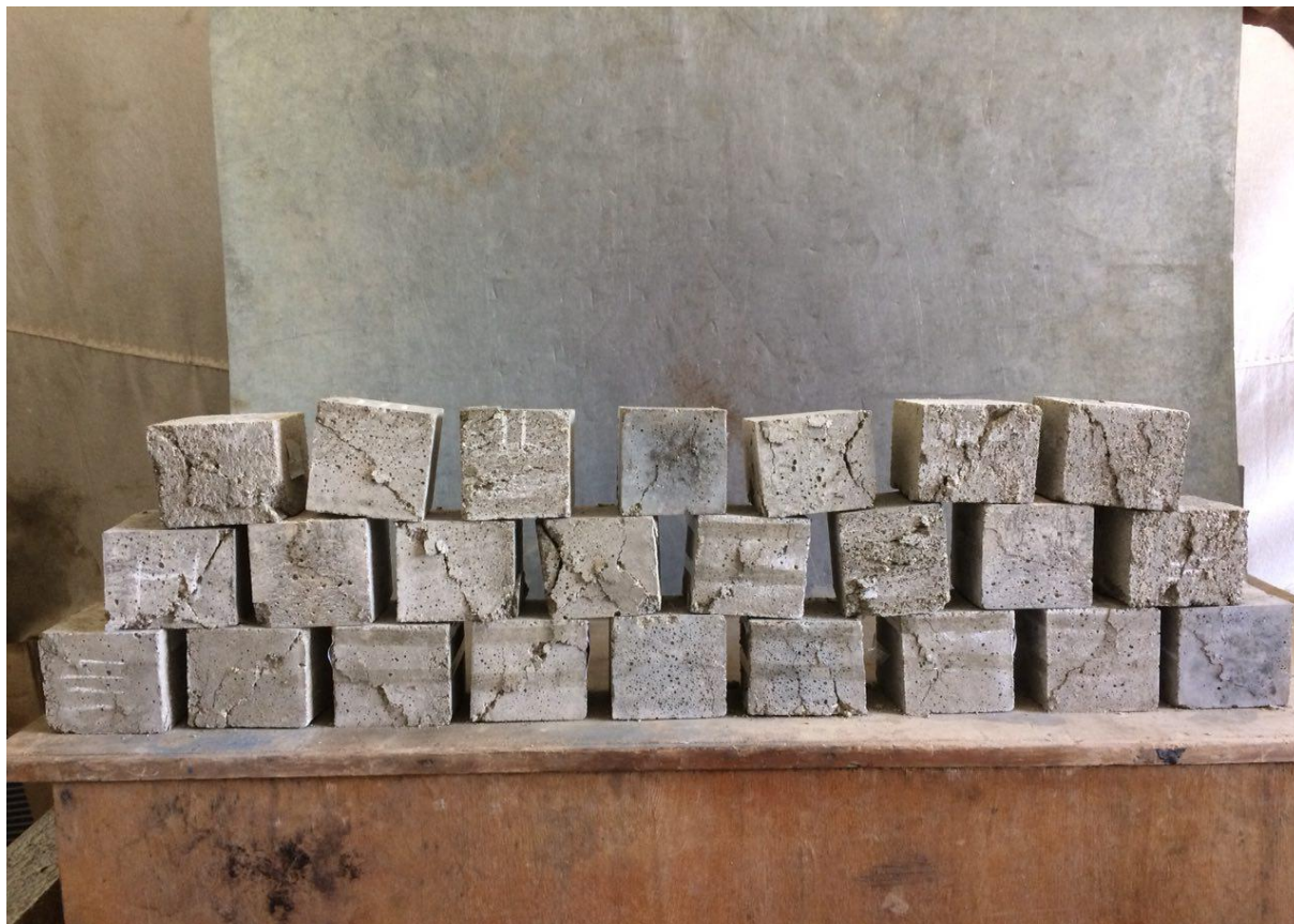
3.7-расм. Тажрибадан ўтказилган куб намуналарнинг умумий кўриниши
