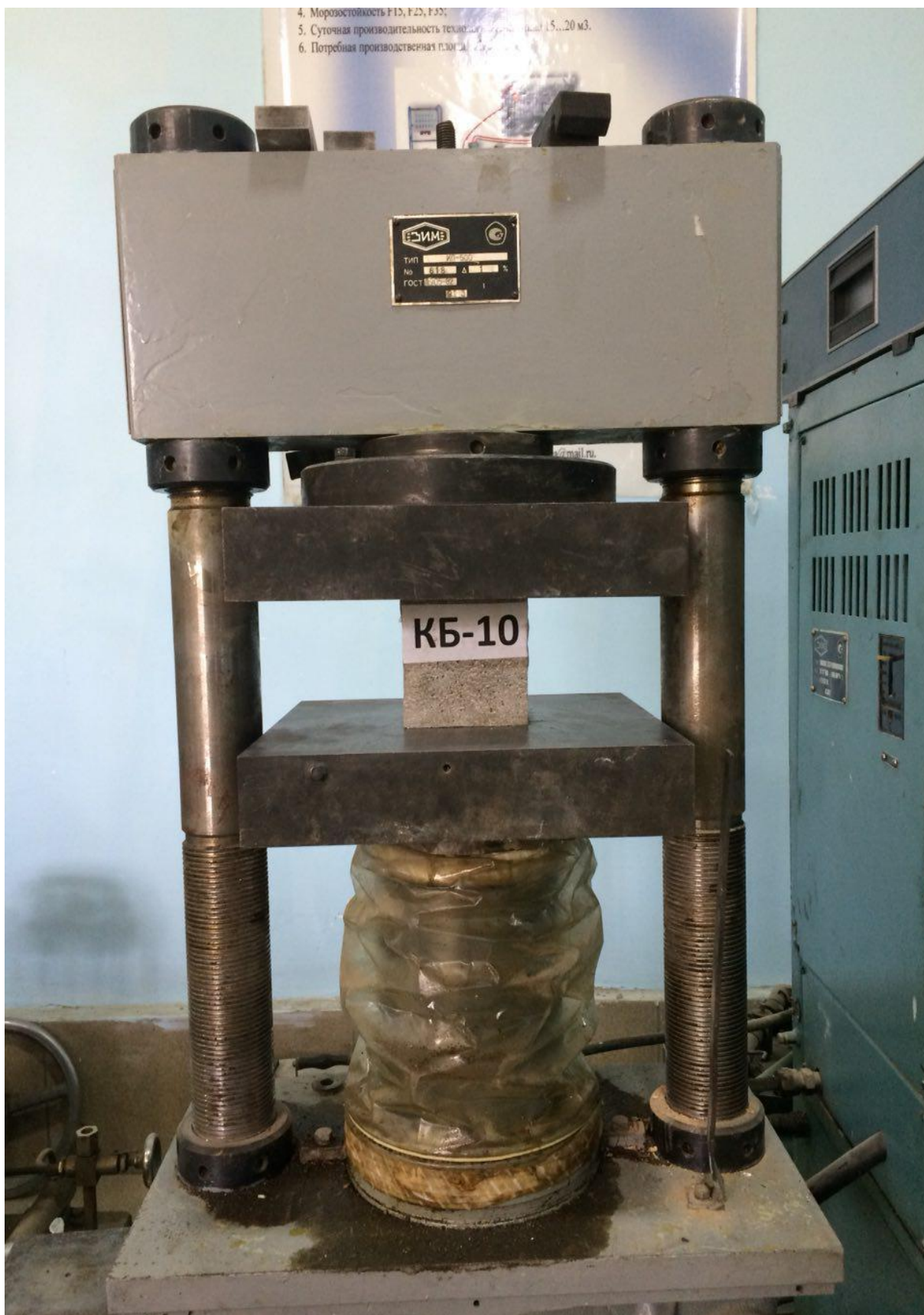
3.1-расм. Оддий енгил бетонларнинг кубик мустаҳкамлигини аниқлаш.
