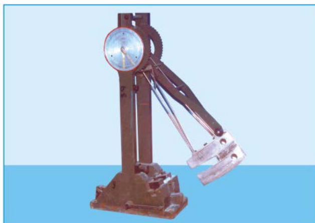
2-rasm. Zarba yopishqoqligini Sharpi metodi bilan tajriba utazadigan qurulma.
