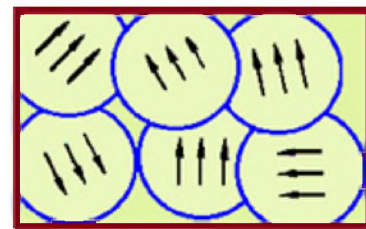
11- rasm. ferromagnetning juda ko'p miqdordagi domenlarga ajralishi.
