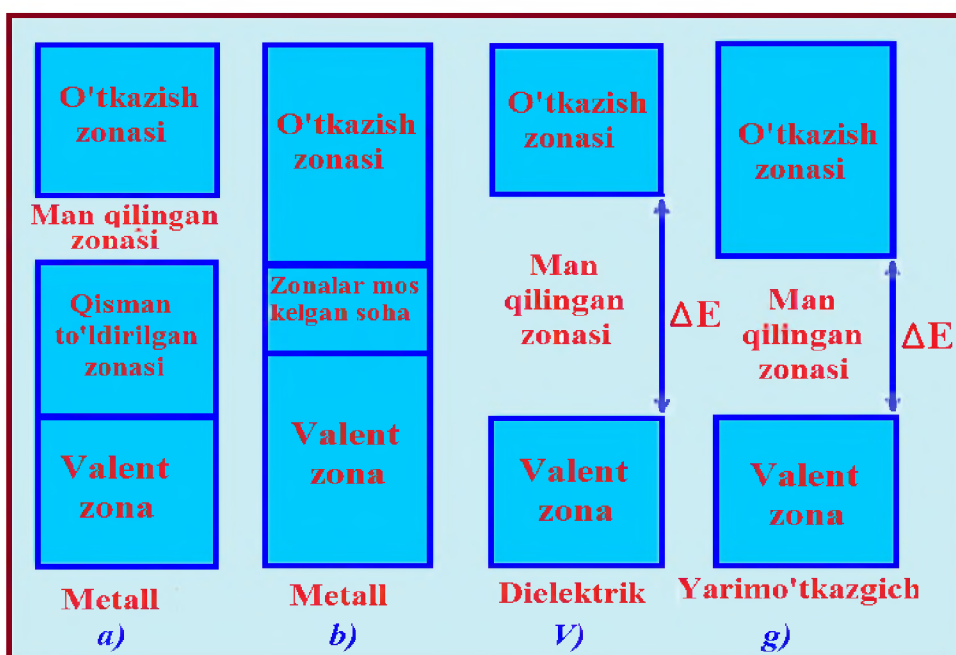
10 - rasm. Metall, dielektrik va yarimo'tkazgichning energetik zonalari.
