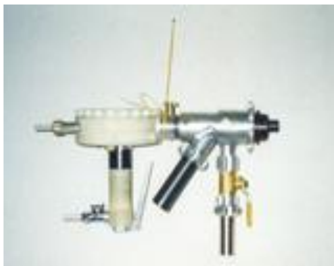
8.3.7 - rasm. Qirqilgan shisha tolasi va sovuq bitum-rezina mastikasini birdaniga tom asosiga yotqizish uchun pistolet-sochuvchining umumiy ko‘rinishi
