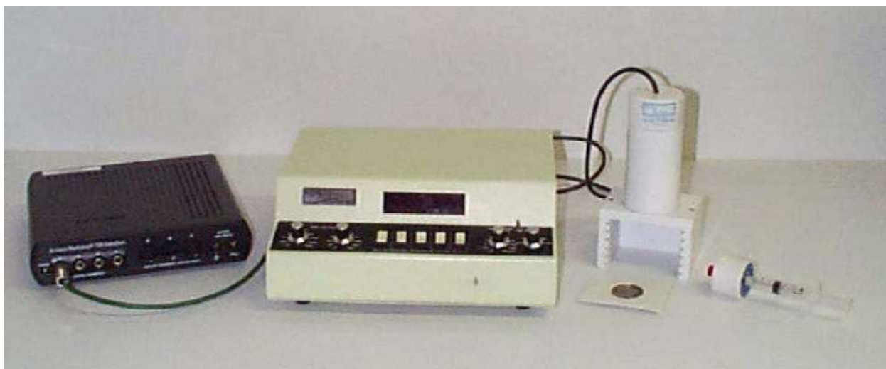
7-súwret. Bariy-137m generatorınıń kórinisi [ http://electron6.phys.utk.edu/phys250/Laboratories/radioactive_halfife_of_ba.htm dereginen alıńan]. Bul generatordıń ishinde ^{137}_{55}\text{Cs} \rightarrow ^{137m}_{56}\text{Ba} + e^- + \nu_e sxeması boyınsha radioaktivli reakciya bolıp ótedi [26].
