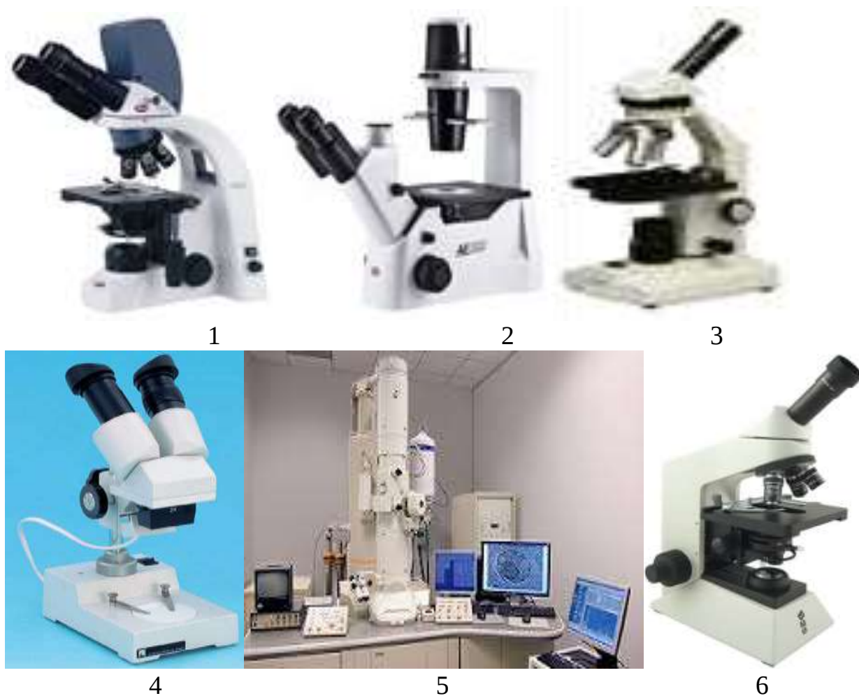
14-rasm. Hozirgi zamon biologik mikroskoplar: 1-Raqamli mikroskop; 2-kamerali binokulyar mikroskop; 3-o'quvchi mikroskopi; 4-Stereo mikroskop LH1L; 5-elektron mikroskop; 6-Monokulya BMS D1-211E mikroskop;
