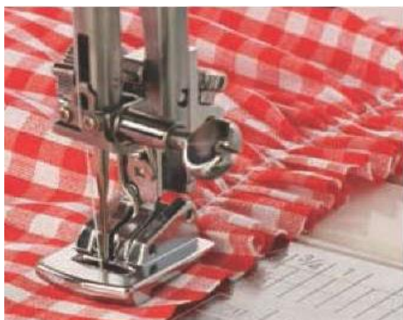
10 –rasm. Kiyimning belqismiga, yeng qismiga, kaketka qismlariga burma berishni mashinada bajarish jarayoni.
