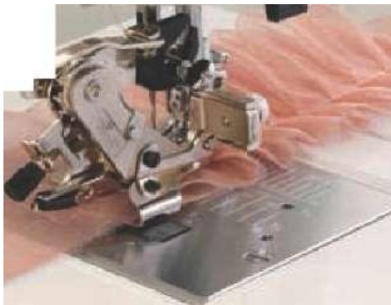
11-rasm. Ko‘ylakning etak qismiga, bel qismlariga, yeng uchiga pir-pirak shaklida burmaberishjarayoni.
