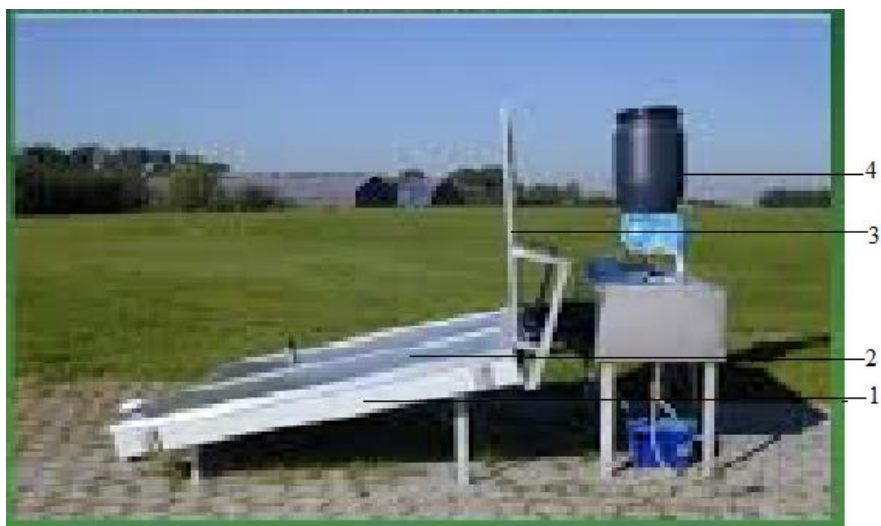
2.3.4- chizma. Quyosh suv chuchitgichi: 1-qurilmani izolyatsiyalangan devori; 2-shisha(shaffof sirt); 3-yorug`likni qaytaruvch sirt; 4-sho`r suv saqlanadigan idish.
