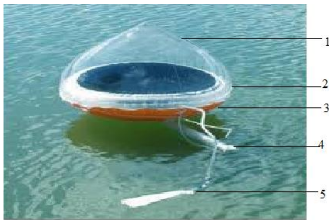
2.3.5- chizma. Konus shaklidagi suv chuchitgich idishining mukammal ko`rinishi.
