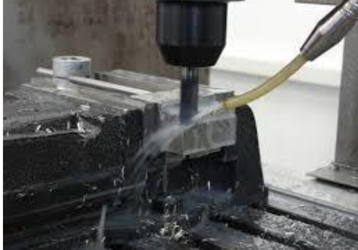
10-расм: Бармоқли фреза билан деталга ишлов беришда СМС ни қўллаш жараёни.
