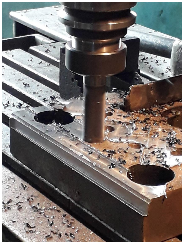
3-расм: Ишлов беришда деталдан қиринди ажралиш жараёни.
