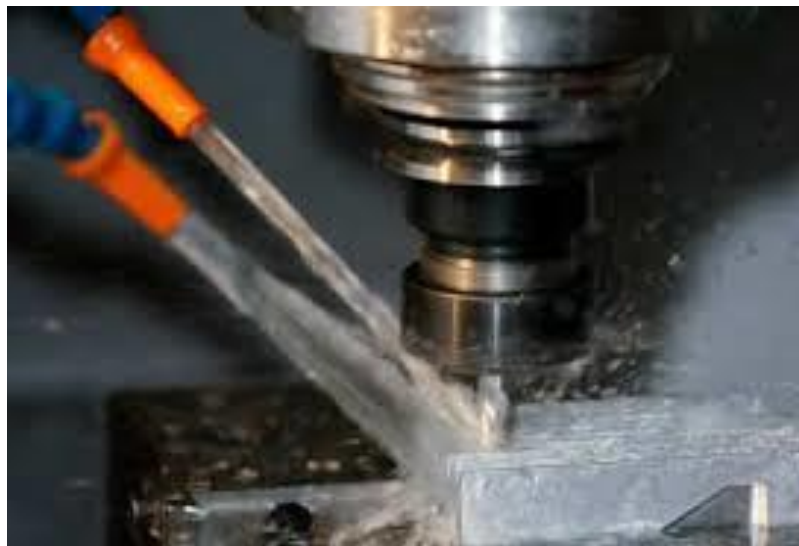
8-расм: СМС ни фрезалаш жараёнида ишлатилиши.
