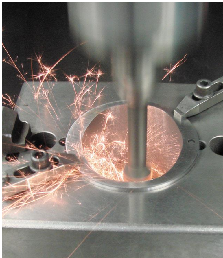
16-расм: Бармоқли фреза билан ишлов бериш жараёнида кесиш зонасида температуранинг ортиши.
