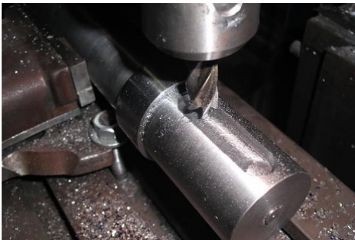
5-расм: Юқори мустаҳкамликка эга бўлган материалдан тайёрланган валга шпонка пазини очиш.
