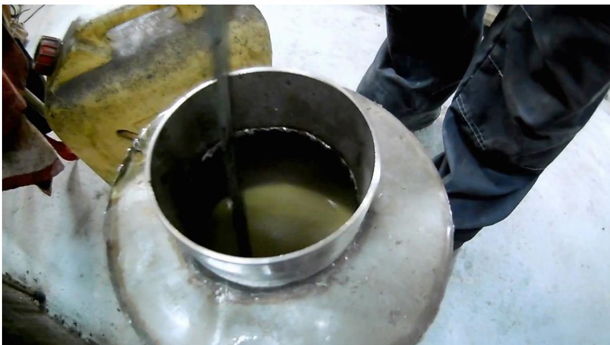
9-расм: Совутиш-мойлаш суюқлигини тайёрлаш жараёни
