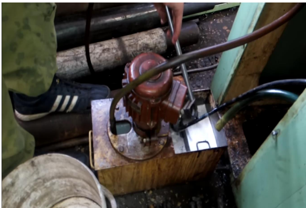
10-расм: Совутиш-мойлаш суюқлигинининг дастгоҳга юбориш
