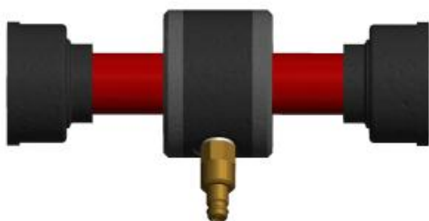
3.4-rasm. Quvurga tez va jips birikadigan qilib yasalgan aylanma o'lchash kamerasining ko'rinishi
