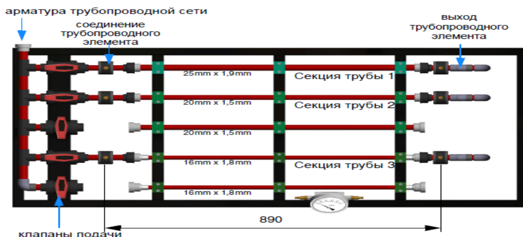
5.1-rasm. Quvur tizimidagi quvur qismlarini kalibrlash
