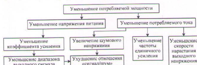
Рис. 1. Влияние потребляемой мощности на характеристики аппаратуры
