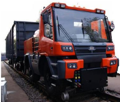
Рисунок 1 – Тяговый модуль ТМВ-2
