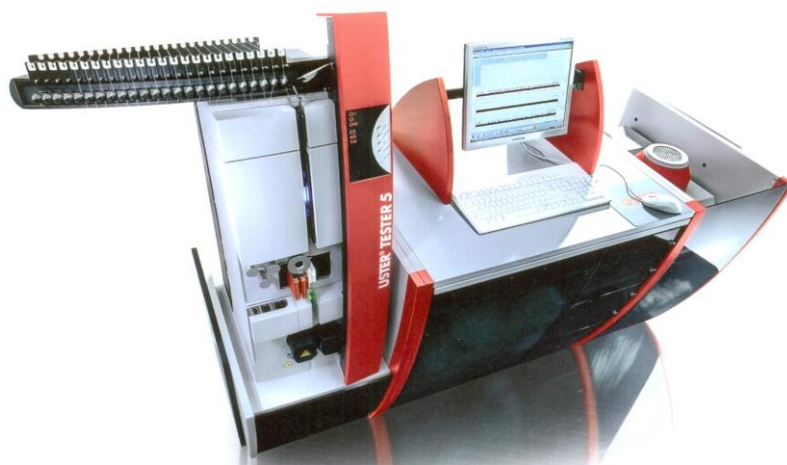
2.2-rasm. Pilta, pilik va ipni notekisligini aniqlash asbobi USTER TESTER 5-S800
