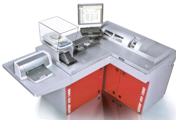
2.1-rasm. Tolaning to'liq xossa ko'rsatkichlarini aniqlashda ishlatiladigan USTER HVI 1000 M1000 asbobi
