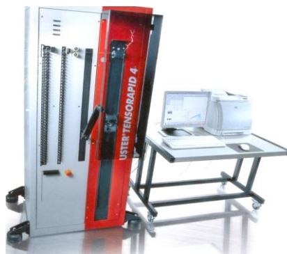
2.3-rasm. Ipni uzulish kuchi, uzulishdagi uzayishini va uzulish vaqtini aniqlash asbobi Kalava iplarning quyidagi sifat ko'rsatkichlarini aniqlaydi:
