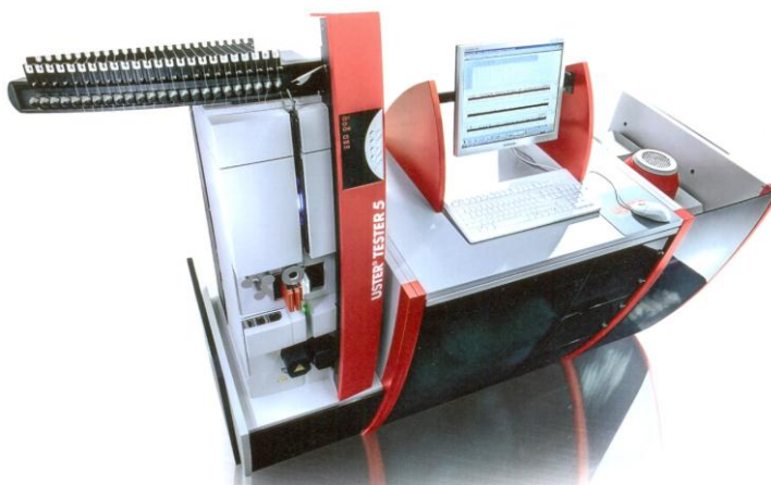
2.2-rasm. Pilta, pilik va ipni notekisligini aniqlash asbobi USTER TESTER 6-S800
