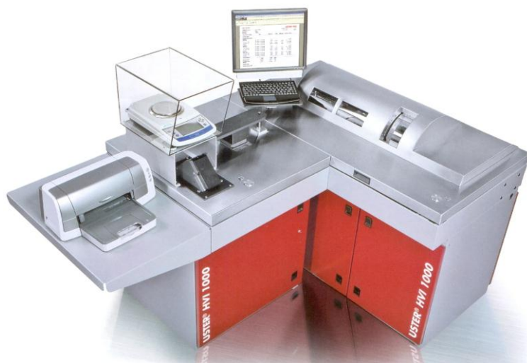
2.1-rasm. Tolaning to'liq xossa ko'rsatkichlarini aniqlashda ishlatiladigan USTER HVI 1000 M1000 asbobi
