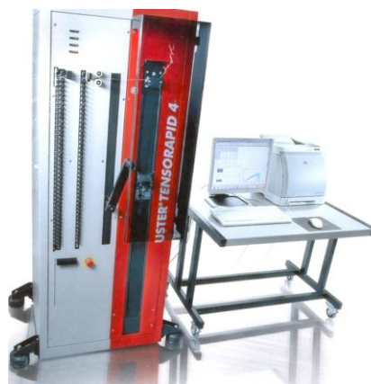
2.3-rasm. Ipni uzulish kuchi, uzulishdagi uzayishini va uzulish vaqtini aniqlash asbobi
