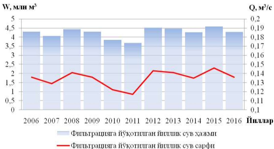
5-расм. Туямўйин гидроузелидан фильтрацияга йўқотилган йиллик сув ҳажми (млн м³) ва сув сарфи (м³/с)
