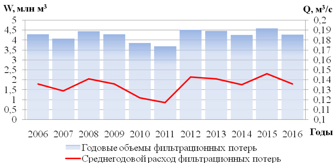
Рис.5. Годовые объем потерь воды на фильтрацию (млн \text{м}^3 ) и расход воды ( \text{м}^3/\text{с} ) в ТМГУ
