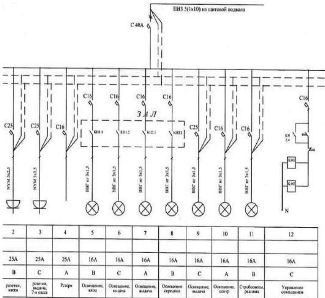
Рис-1. Однолинейная схема электроснабжения школы.
