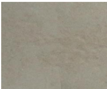
Базальт тола ва топинамбур пояси целлюлозаси асосида олинган қоғоз (1:1)
