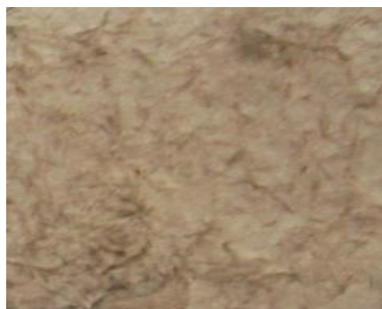
Базальт тола ва ғўзапояси целлюлозаси асосида олинган қоғоз (1:1)
