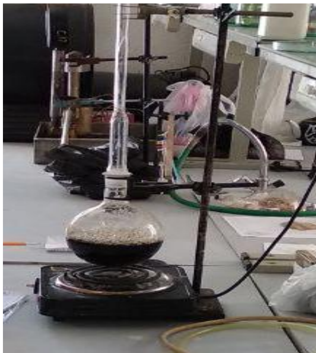
8-Расм. Канақунжут поясидан лаборатория шароитида целлюлоза пишириш
