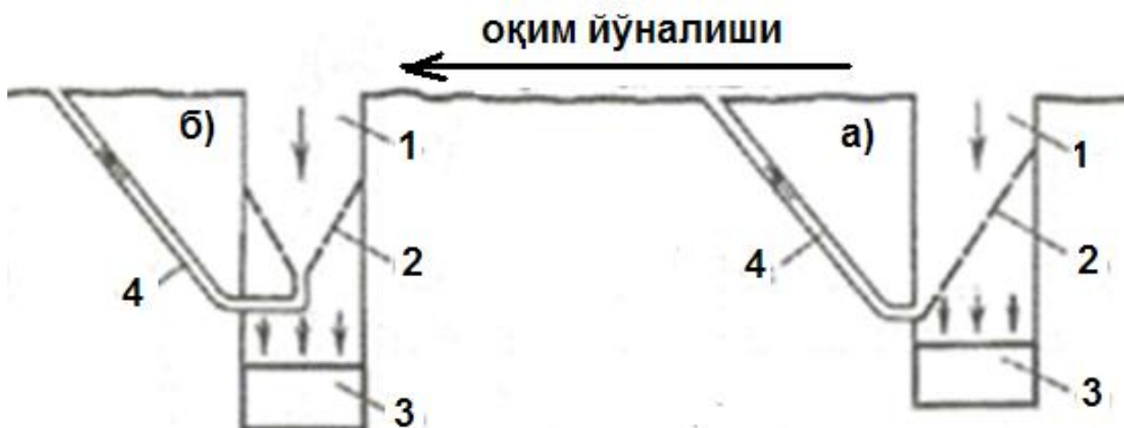
9-расм. Сув олиш иншоотигатик ўрнатилган ясси симтўрли балиқларни ҳимоя қилиш-тўсиш иншооти:
