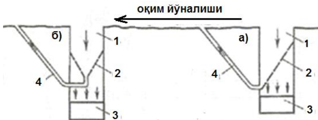
4-расм. Сув олиш иншоотигатик ўрнатилган ясси симтўрли балиқлар- ни химоя қилиш-тўсиш иншооти:
